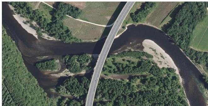
Cela contraint la rivière à dissiper son énergie au niveau des derniers secteurs mobiles, comme au niveau du pont de l'autoroute A20 en amont de Souillac (Cf. photo 21).
